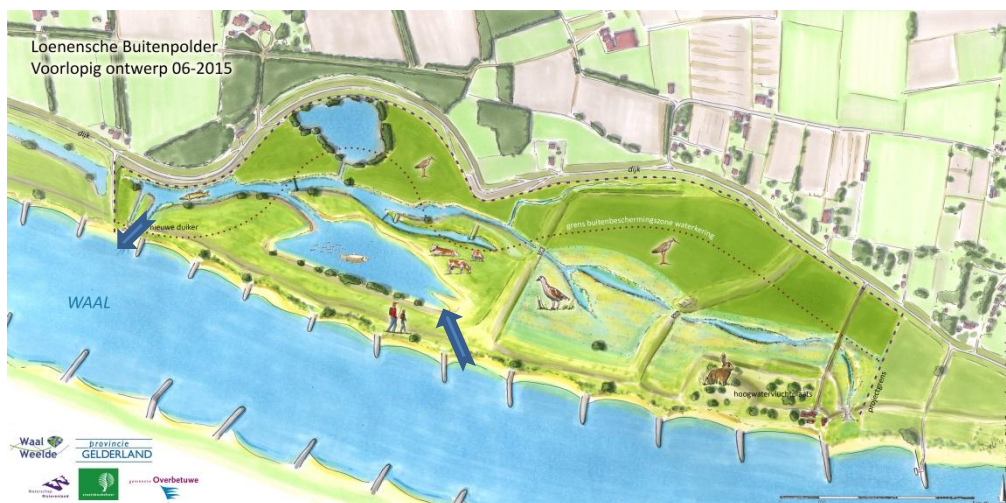
Figuur 1. Optimalisatie van de in- en uitstroomopeningen in het VO Loenense Buitenpolder
